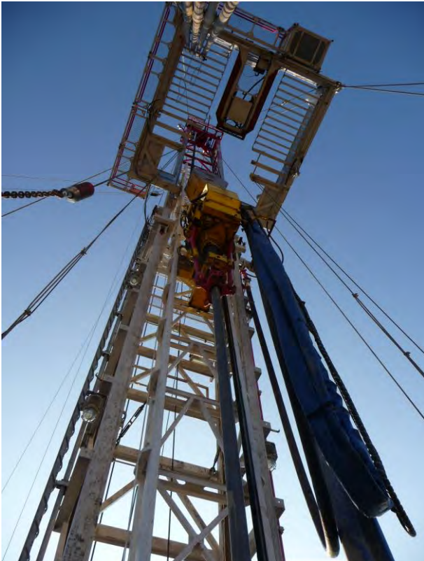
Abb. links: „TOP-Drive“- zum Antrieb des Bohrgestänges; © RP Darmstadt
