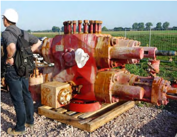
Abb.: Der sog. "Blow-Out-Preventer" (als zentrales Sicherheitselement einer Tiefbohrung); © RP Darmstadt
