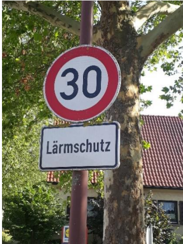
Abbildung 1: Geschwindigkeitsreduzierung aufgrund Lärmschutz 7
