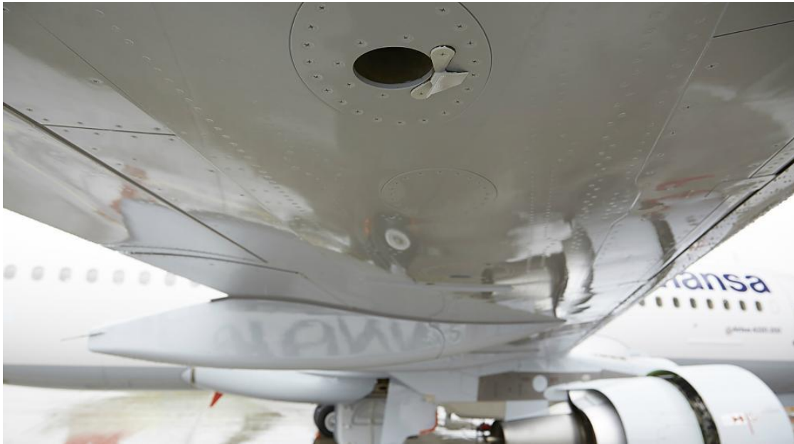
Abbildung 49: Ein Wirbelgenerator an der Tankdruckausgleichsöffnung montiert ©UNH 180
