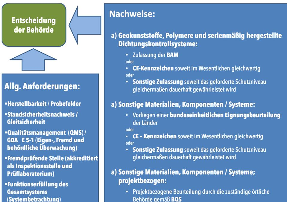
Abb. 2: Deponiebautechnik: (Geologische) Barrieren - Allg. Anforderungen und Nachweisführung
