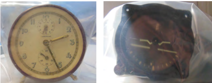
Abb.: Wecker mit Radiumleuchtfarbe (links), Künstlicher Horizont aus einem Flugzeug mit Radiumleuchtfarbe (rechts); © RP Darmstadt
