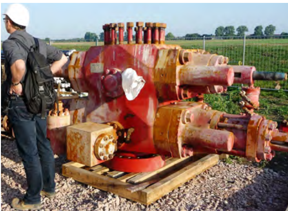
Abb.: Der sog. „Blow-Out-Preventer“ (als zentrales Sicherheitselement einer Tiefbohrung); © RP Darmstadt
