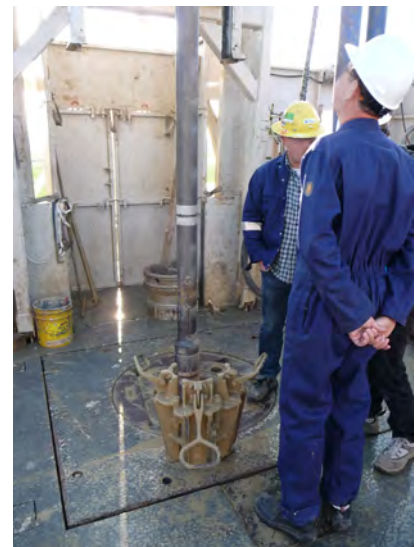
Abb.: Bohrtisch mit Bohrgestänge (im Vordergrund Keile); © RP Darmstadt
