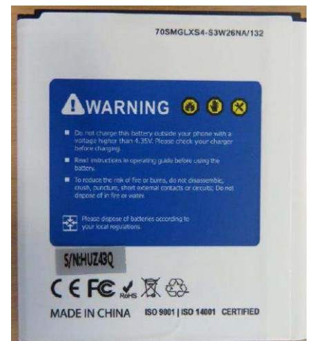
Abb. 1: Handyakku „Made in China“, Kennzeichnung ist zu klein (© HZA Frankfurt am Main)
