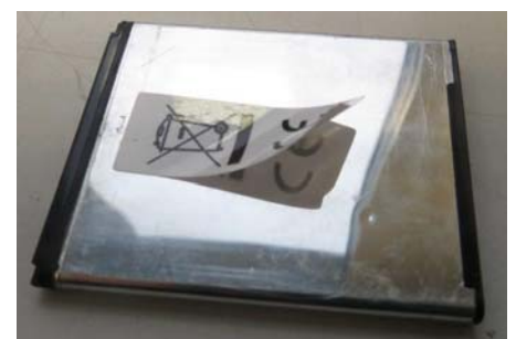
Abb. 2: Kennzeichnung ist nicht dauerhaft angebracht, die Kapazitätsangabe fehlt (© HZA Frankfurt am Main)
