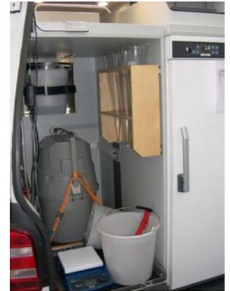
**Abb. 5:** Immer schön kühl bleiben: Im hinteren Teil des Busses steht rechts der Kühlschrank. Daneben Probenahmeimer, automatisches Probenahmegerät und Sedimentiertrichter (© RP Darmstadt)
