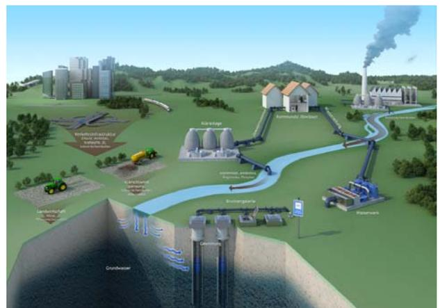
**Abb. 1:** Anthropogene Spurenstoffe - mögliche Eintragungspfade in das Grundwasser (© Hessenwasser GmbH&Co KG)
