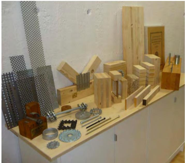
**Bild: Verschiedenste Modelle der Holz-Stahl-Konstruktionen**
