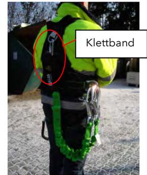
Bild: Gurt mit Bandfalldämpfer
