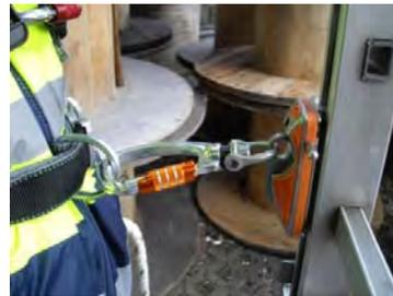
Bild: Läufer als Verbindungsmittel zwischen Mensch/Gurt und Leiter
