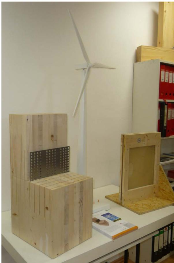
**Bild:** Modelle der Holz-Stahl-Klebeverbindungen
