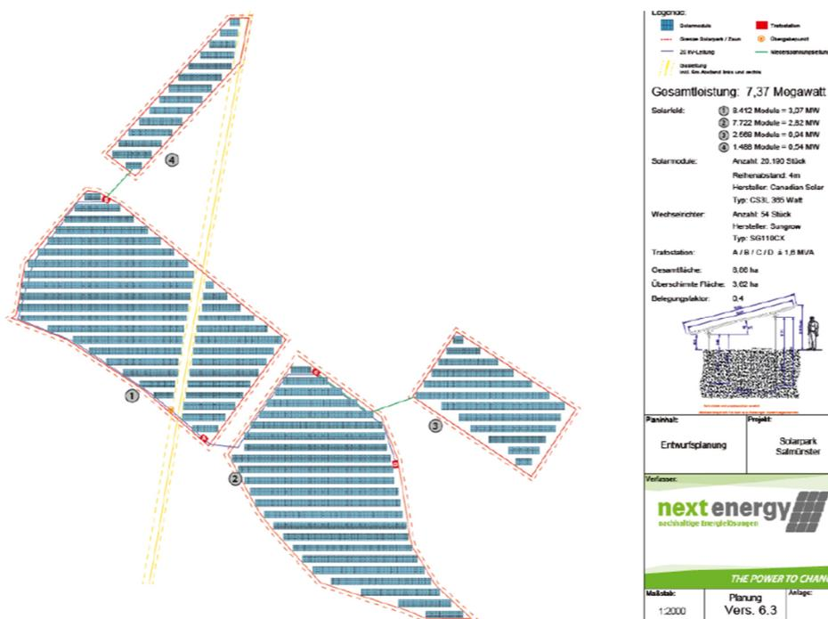
Abbildung 7: Entwurfsplanung der Photovoltaikanlage. Quelle: next energy.
