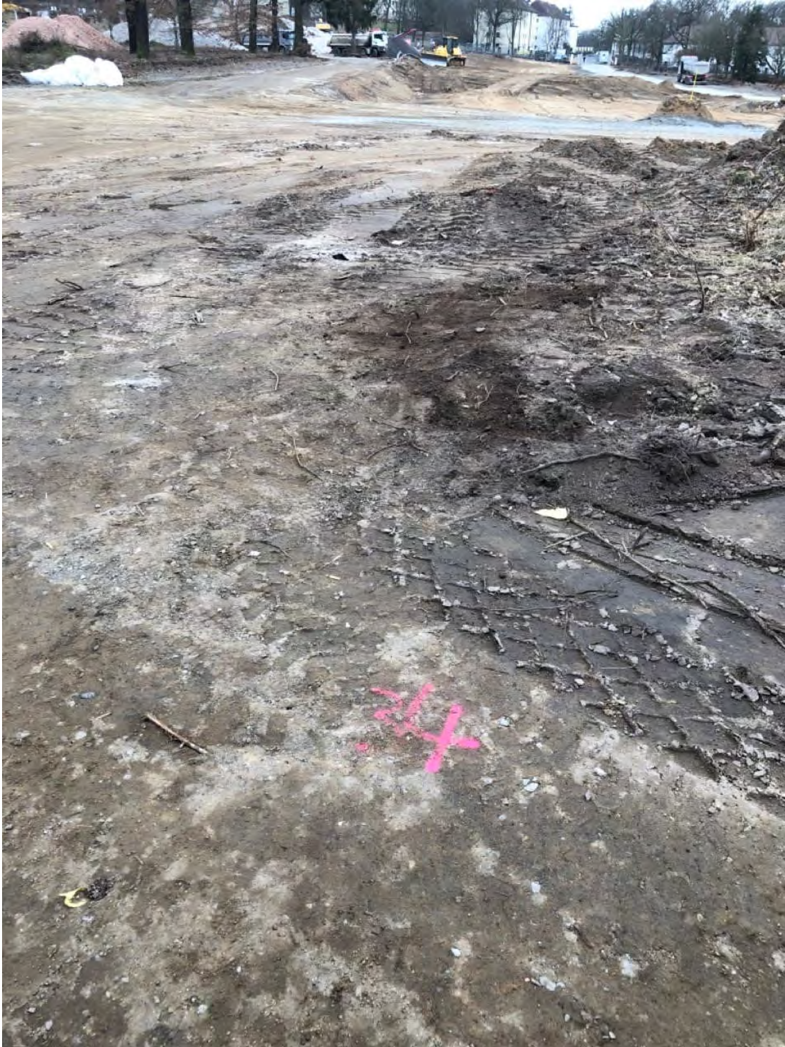
Bohransatzpunkt KRB/DPH 34 nach dem Verschließen
