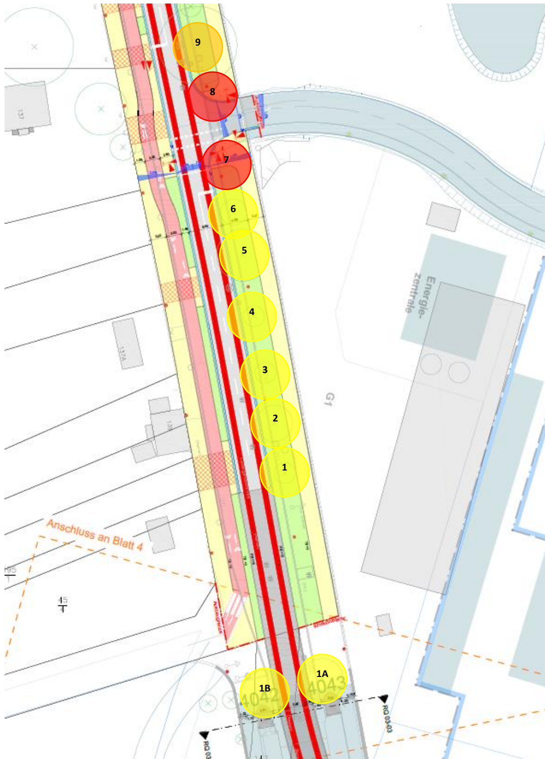
Abbildung 5: Planausschnitt Vorabzug Entwurfsplanung, Ludwigshöhstraße Teil 3 (südlichster Abschnitt), begutachtete Bäume nachträglich mit Nummern markiert, rot = nach Einschätzung GA 222_0014 nicht zu erhalten, gelb = kritisch durch Gleisbauarbeiten betroffen, orange (Nr. 9 – 16) = zusätzlich kritisch durch Leitungsbau betroffen; Quelle: HEAG mobilo GmbH
