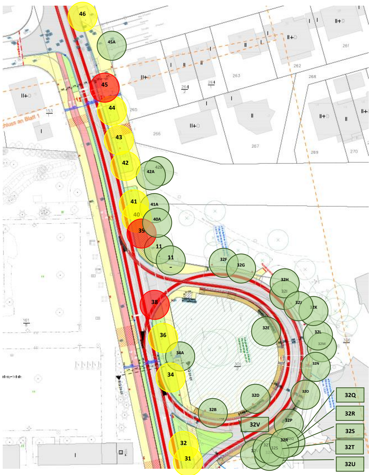
Abbildung 3: Planausschnitt Vorabzug Entwurfsplanung, Ludwigshöhstraße Teil 1 (nördlichster Ausschnitt), begutachtete Bäume nachträglich mit Nummern markiert, rot = nach Einschätzung GA 222_0014 nicht zu erhalten, gelb = nach Einschätzung GA 222_0014 kritisch durch Gleisbauarbeiten betroffen; Quelle: HEAG mobilio GmbH
