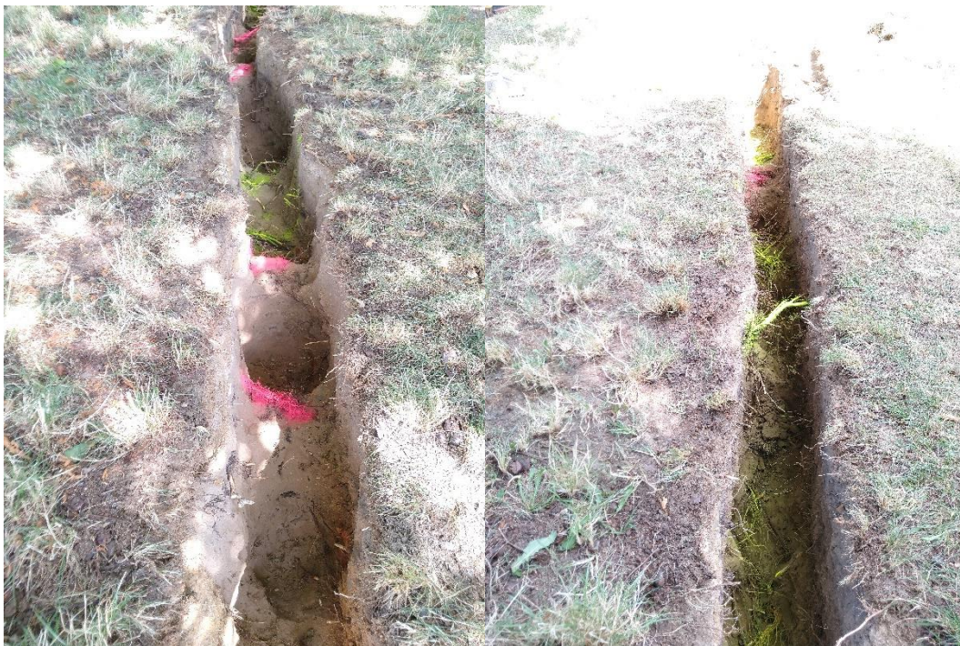
Abbildung 13: Gehwegseitiger Wurzelsuchgraben an Baum 9 und 10, links: Schwach-, Stark- und Grobwurzelfunde, wahrscheinlich Baum 9 zuzuordnen; rechts: Schwachwurzelfunde und 1 Grobwurzelfund, vermutlich Baum 10 zuzuordnen
